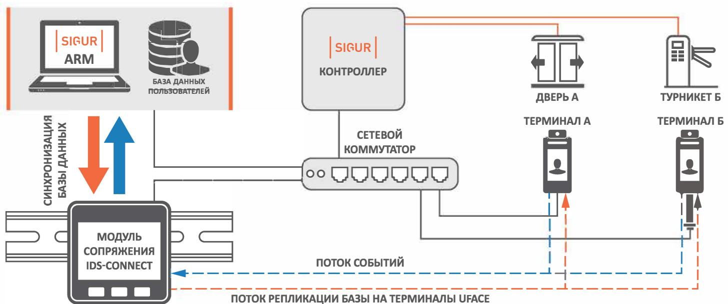
В результате включения в работу модуля сопряжения IDS-Connect пользователь получает возможность переносить и динамически изменять всю базу пользователей из СКУД SIGUR на терминалы в точках прохода, продолжая работу в привычной графической среде ПО SIGUR и управляя исполнительными устройствами через контроллер SIGUR.
