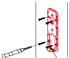
При подключении внешней коммутации отсоедините провод, проходящий здесь
