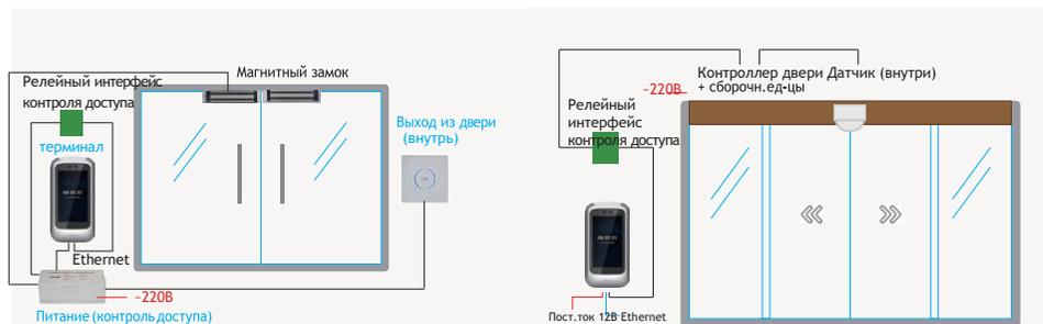
Схема установки для двери с магнитным держателем
